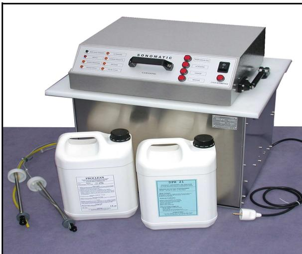
SNC 30E avec dispositifs de pompage et contrôle de niveau des produits PROCLEAN (nettoyage) et DPH 21 (rinçage final).
